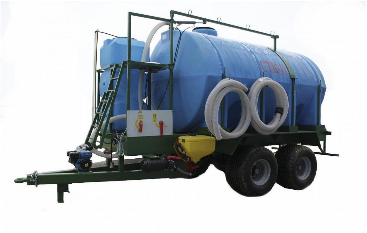
Смешиватель транспортировочный комбинированный СТК предназначен для приготовления раствора для химической защиты различных культур и быстрого перекачивания приготовленной жидкости в опрыскиватель.
